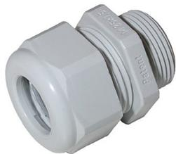
Pressacavo M16x1,5 con O-ring, campo di serraggio Ø 6.0-8.0mm in plastica per scatole di giunzione IP68
