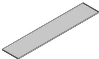
fabricado en aluminio de 2mm con incrustación de chapa de acero galvanizado de 2mm de espesor. dimensión: 1000x299x7mm altura del borde interior puede ser cubierto: 3mm
