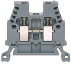
Reihenklemme DIN35 4mm<sup>2</sup> 45x6x36mm grau. Schrauben aus rostfreiem Stahl (A2), beidseitig 4-stellige Bezeichnungsmöglichkeit, für Querverbindungen versenkt
