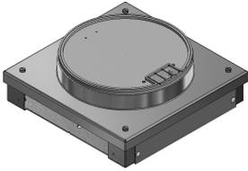
Plenum Ø220 BAK5 284x284/50 con marco y tapa de aluminio fundido a presión con borde de protección, altura del borde 5mm
