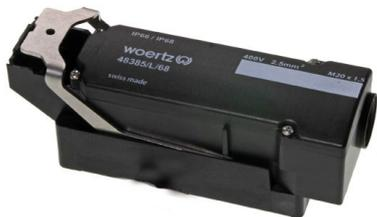
Anschlussdose 5P IP66/IP68, werkzeuglose Kontaktierung zur abisolierfreien Einspeisung oder Abzweigung, mit Schraubanschluss für Starkstrom, längsabgehend, Gewinde M20x1.5
