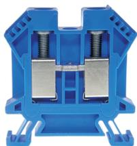
Morsettiera DIN35 16mm<sup>2</sup> 55x11x55mm blu con contatto ottimale, viti in acciaio inox, possibilità di marcatura a 4 cifre su entrambi i lati, incassata per connessioni incrociate
