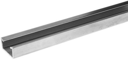
Guida profilata C30 da 29x15x2 mm in acciaio inox V2A, con una lunghezza di 3 metri.
