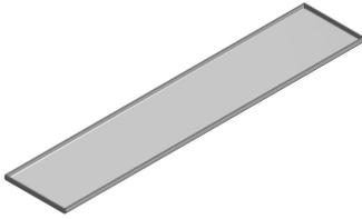
aus Aluminium 2mm mit verzinkter Stahlblecheinlage 3mm getoxt. Abmessung: 1000x199x7mm Kantenhöhe innen belegar: 3mm
