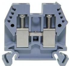
Morsettiera DIN35 10mm<sup>2</sup> 45x8x42mm grigia con il miglior contatto possibile, viti in acciaio inox, possibilità di marcatura a 4 cifre su entrambi i lati, incassata per connessioni incrociate
