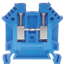
Bloc de jonction DIN35 2.5mm<sup>2</sup> 46x6x43mm bleu avec le meilleur contact possible, vis en acier inoxydable, possibilité de repérage à 4 chiffres des deux côtés, encastré pour les connexions transversales
