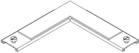
pour relier la coque du canal pour rail DIN-35 en cas d'onglet plat à 90°.
