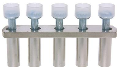
Connexion transversale isolée à 5 pôles pour bornes sur rail DIN32/35 50mm<sup>2</sup>, vis M4 incluses. Dimensions : 68.4x35.8 mm
