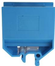
Borne de derivación sin pieza de empuje, tornillos prisioneros con ranura, piezas metálicas de latón niquelado, deslizador antidesplazamiento para conductores pasantes, opción de marcado de 4 dígitos
