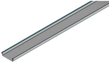
aus sendzimir-verzinktem Stahlblech 1.5mm beidseitig in Spezialaluminiumprofil Woertz eingepresst mit provisorischer Schutzkante in Nut eingelegt und Trittschalltrapezgummi als Deckelauflage inklusive Befestigungslaschen und Verbindungsmaterial Hohe 60mm / Deckelnennbreite 200mm Länge: 2000mm
