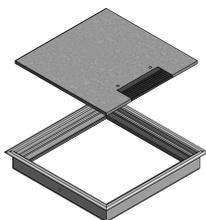
Cadre à suspendre pour découpe 131x131mm en aluminium anodisé naturel, épaisseur d'appui 2mm, aplati, couvercle 124x124mm en acier galvanisé sendzimir 6mm, à garnir 5mm, avec baguette à brosse noire 101x25mm
