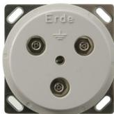
Vitre frontale Ø 63mm, blanche, sans boîte d'encastrement. Pour montage dans une boîte NIS. Contacts enfichables avec douilles à ressort, Ø 6mm , argentés, avec verrouillage Bride de raccordement arrière pour conducteurs jusqu'à 16mm
