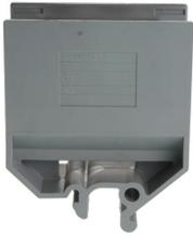
Abzweigklemme ohne Druckstück, Gewindestifte mit Schlitz, Metallteile Messing vernickelt, Spreizschuttschieber für Leiter durchgehend, 4-stellige Bezeichnungsmöglichkeit
