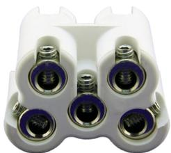
Einspeis- / Verbindungs Dosen E90, zur Einspeisung (Rundkabel-Flachkabel) oder Verbindung (Flachkabel-Flachkabel) für Flachkabel 5G16mm<sup>2</sup>. Mit Schrumpfschlauch IP66/68.
