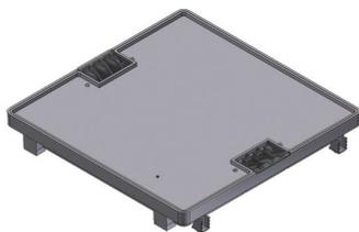
Cadre et couvercle en aluminium coulé sous pression avec bord de protection, pour revêtement de sol 5mm, avec 2 creux pour câbles Art. n° 51518
