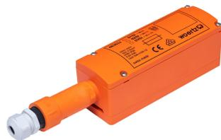
Caja de empalme E90 con adaptador de fusible IP66/68 para cable plano FE180 E90 5G2,5mm 2 con 3 prensaestopas M20x1,5 Ø6,0 - 15,0mm Versión específica para el proyecto a petición (ver documento/G00'299)
