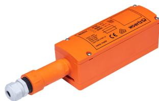
Boîtier de dérivation E90 avec adaptateur de fusible IP66/68 pour câble plat WOERTZ FE180 E90 5G2.5mm<sup>2</sup> avec 3 presse-étoupes M20x1.5 Ø6.0 - 15.0mm Conception spécifique au projet sur demande (voir Document/G00'299)
