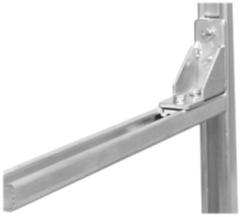
Aus Stahlblech 3 mm, verzinkt, mit Sechskant-Schlitzschrauben aus Stahl verzinkt M16x16, Federringen und Nutensteinen zum Einsetzen in Profilschiene Nr. 4283, Typ C30, mit 4 Schrauben und 2 Ankerplatten 50 mm lang
