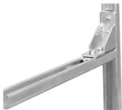
De chapa de acero de 3 mm, galvanizada, con tornillos hexagonales ranurados de acero galvanizado M16x16, arandelas elásticas y tacos deslizantes para insertar en el carril perfilado nº 4283, tipo C30, con 4 tornillos y 2 placas de anclaje de 50 mm de longitud
