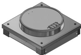
Boîtier de raccordement Ø220 BAK5 284x284/40 avec cadre et couvercle en aluminium coulé sous pression avec bord de protection, hauteur de bord 5mm avec 1 bac à câbles 53961 pour hauteur de sol 102-132mm
