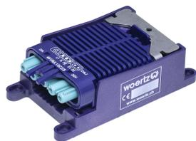
Boîtier de dérivation rapide IP20/IP40 avec douille 5 pôles code2 (DALI), L1-N-PE-D1-D2, 250V 20A, pour câble plat no.49945/OS,49946/OS
