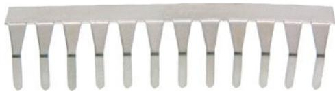
Râteau de raccordement transversal en laiton nickelé, pour petites bornes à vis 2,5 mm<sup>2</sup>, avec pas de 5 mm
