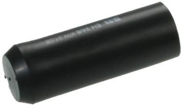
Kabelendstück Schrumpf - Endabschlusskappe, Durchmesser 55mm nach Schrumpfung 25mm , Länge 165mm , schwarz. Innenseite mit Kleber und Dichtmasse beschichtet.
