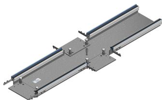
en tôle d'acier galvanisée sendzimir 1.5mm pressée des deux côtés dans un profilé spécial en aluminium Woertz avec bord de protection provisoire inséré dans une rainure et caoutchouc trapézoïdal contre les bruits d'impact comme support de couvercle, y compris pattes de fixation et matériel d'assemblage hauteur 60mm / largeur nominale du couvercle 200mm longueur : 1000mm nivelé intérieur.
