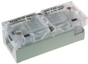
Anschlussdose für Flachkabel multibus 4x1.5 mm<sup>2</sup> - 4-polig für 2 Rundkabel 4x0.75 mm<sup>2</sup> mit 4 Flachkabelkontakten zum Einspeisen oder Abzweigen.
