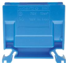
Abzweigungsklemme ohne Druckstück, Gewindestifte mit Schlitz, Metallteile Messing vernickelt, Spreizschuttschieber für Leiter durchgehend, 4-stellige Bezeichnungsmöglichkeit
