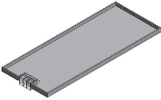
aus Aluminium 2mm mit verzinkter Stahlblecheinlage 2mm getoxt. Abmessung: 500x299x7mm Kantenhöhe innen belegbar: 3mm Kabelmulde lose beigelegt
