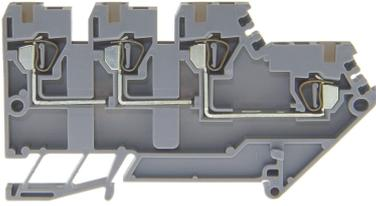
Initiatorenklemme DIN35 1.5mm<sup>2</sup> 10A 60V mit 4 Anschlüssen, Bezeichnungsmöglichkeit in der Mitte, für Querverbindung versenkt.
