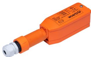
Boîte de dérivation E90 avec adaptateur de sécurité IP66/68 pour câble plat FE180 E90 5G4 mm<sup>2</sup>, y compris 3 presse-étoupes M20x1,5 Ø 6-8 mm, Ø 8-11 mm, Ø 11-15 mm.
