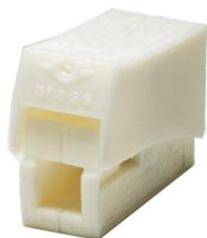
Disponibile in bianco. Collega i conduttori in rame a filo singolo con i cavi di alimentazione degli apparecchi di illuminazione. 2 punti di fissaggio per il lato installazione (da 0,75 mm<sup>2</sup> a 2,5 mm<sup>2</sup>). 1 punto di morsetto per il lato apparecchio (da 0,5 mm<sup>2</sup> a 2,5 mm<sup>2</sup>). 100 pezzi per scatola.
