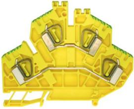
Grün-gelbe Doppelstock-Zugfederklemme DIN35 4mm<sup>2</sup> mit 2x2 Anschlüssen Bezeichnungsmöglichkeit seitlich und in der Mitte mit Streifen, für Querverbindung versenkt.
