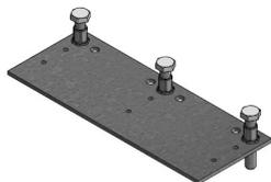
de chapa de acero galvanizado sendzimir 4mm Dimensiones: 360x100mm con 3 tornillos hexagonales de nivelación M10x60 de poliamida con remaches ciegos para la fijación a la carcasa del canal para el montaje adicional en caso de falta de conexión.
