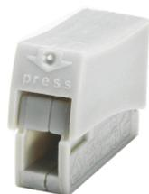
Disponibile in grigio. Collega i conduttori in rame monofilari ai cavi di alimentazione degli apparecchi di illuminazione. 1 punto di fissaggio per il lato installazione (da 0,75 mm<sup>2</sup> a 2,5 mm<sup>2</sup>). 1 punto di fissaggio per il lato apparecchio (da 0,5 mm<sup>2</sup> a 2,5 mm<sup>2</sup>). 100 pezzi per scatola.
