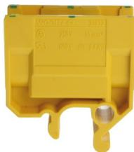
Borne de derivación sin pieza de empuje, tornillos prisioneros con ranura, piezas metálicas de latón niquelado, deslizador antidesplazamiento para conductores pasantes, opción de marcado de 4 dígitos
