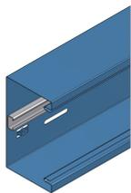
en tôle d'acier galvanisée de 1mm avec rail d'ancrage 29x15x2mm, matériel de connexion et fil de terre inclus
