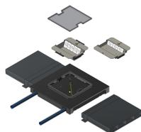
Sistema de suelo con plenum de conexión cuadrado y rejillas de acero al cromo/aluminio, altura del borde 12 mm para conducto de suelo UFK 400x50.
