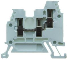
Y-Reihenklemme DIN35 2.5mm<sup>2</sup> weiss mit 3 Anschlüsse mit Schrauben aus rostfreiem Stahl, beidseitig 3-stellige Bezeichnungsmöglichkeit, für Querverbindungen versenkt
