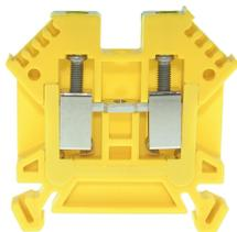
Borne sur rail DIN35 4mm<sup>2</sup> 49x6x45mm isolée vert-jaune avec le meilleur contact possible, vis en acier inoxydable, possibilité de repérage à 4 chiffres des deux côtés, encastrée pour les connexions transversales
