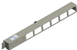
de chapa de acero galvanizado de 1,5 mm con tornillo moleteado para la fijación lateral en la carcasa del canal. Dimensión: 525x47(53)x40mm Color: RAL 7032 gris guijarro Equipado: 1 pieza de abrazadera de agujero ciego 10x2,5mm <sup>2</sup> 10128
