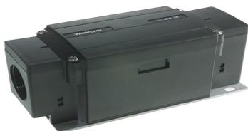
Boîte de dérivation à 5 pôles pour câble plat 5x16mm<sup>2</sup> ou 5G25mm<sup>2</sup> avec fixation par 2 manchons filetés M25x1.5 pour 2 départs avec câble rond. 1 départ max. 5x10mm<sup>2</sup>, 2 départs max. 5x6mm<sup>2</sup> chacun, avec curseur en aluminium. Pour l'application en tunnel, utiliser l'article 49616.
