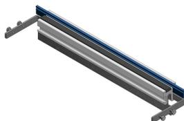
de chapa de acero galvanizado Sendzimir de 1,5 mm prensada en un perfil especial de aluminio Woertz con borde de protección temporal insertado en la ranura y caucho trapezoidal resistente a los impactos como soporte de la cubierta incluido el material de conexión altura 80 mm / anchura nominal de la cubierta 300 mm
