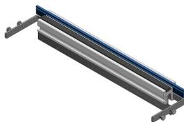
in lamiera d'acciaio zincata sendzimir 1,5 mm pressata in un profilo speciale di alluminio Woertz con bordo di protezione temporaneo inserito nella scanalatura e gomma trapezoidale antiurto come supporto del coperchio, compreso il materiale di collegamento Altezza 80 mm / larghezza nominale del coperchio 300 mm
