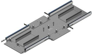
Kreuzverbindung BOK 8880/400x80 mit integrierter Nivellierung aus sendzimir-verzinktem Stahlblech 1.5mm beidseitig in Spezialaluminiumprofil Woertz eingepresst mit provisorischer Schutzkante in Nut eingelegt und Trittschalltrapezgummi als Deckelauflage
