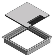
Cadre à accrocher pour découpe 231x231mm en aluminium anodisé naturel, épaisseur d'appui 2mm, aplati. Couvercle visible 224x224mm, en aluminium anodisé, avec bague à brosse noire 101x25mm
