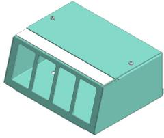
Version courant faible Dim. 132x169x75mm en tôle d'acier galvanisée 1.5mm Couleur: RAL 6027 vert
