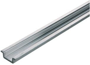
Tragschiene DIN15 mit 15x5x1.5 mm, aus Alu-Legierung, mit einem 16 mm<sup>2</sup> Kupferquerschnitt nach EN 60715 TH 15, 2 m Länge
